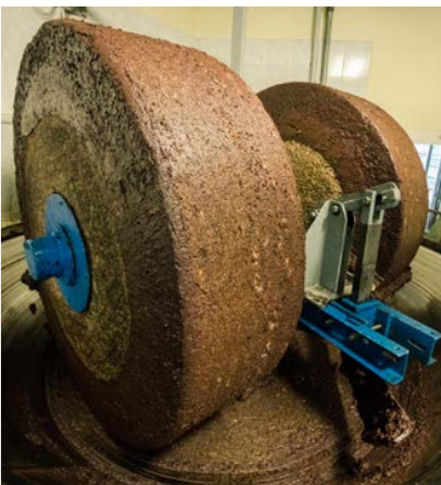
Olivpress med rullstenar. Oliverna och kärnorna mals ner till trögflytande olivpasta som sedan pumpas till malaxeringen.
