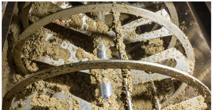
Malaxering av olivpasta, som syftar till att skilja olivoljan från vattnet. oliveCEPT kan minska behovet av malaxering med två tredjedelar.
