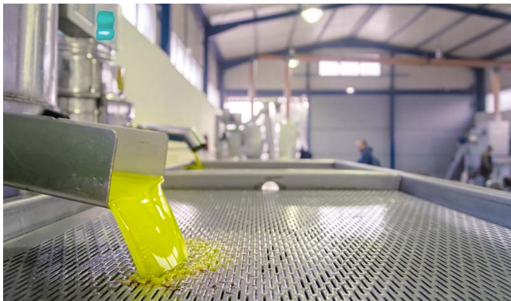
Färdig kallpressad extra jungfrulig olivolja (EVOO) från dekantern passerar genom ett filter och ner i en tank.
