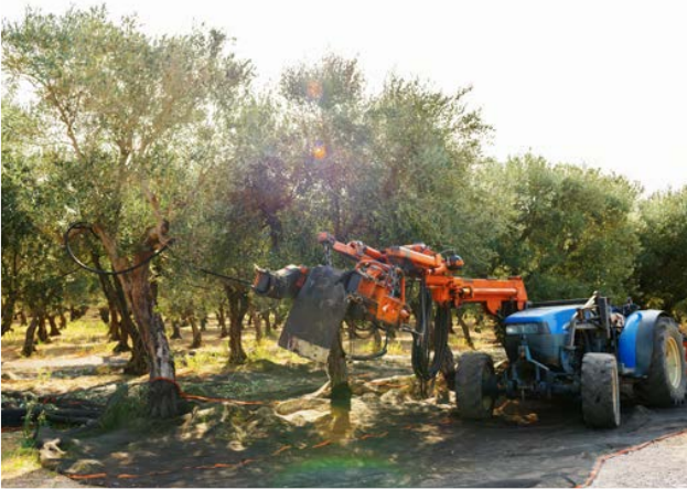
En traktor med skakustruktur i fronten (från Italien). Traktorn greppar runt trädstammen och skakar ner oliverna på nätet.
