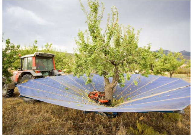
Denna variant av traktor med nedskakning har ett paraply som slås ihop runt trädet och som oliverna skakas ner i (från Spanien).
