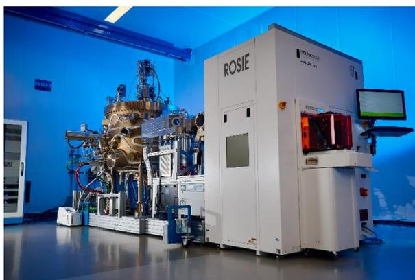
Cette commande marque une étape importante dans le développement de la plateforme ROSIE, dernière innovation de RIBER. Entièrement automatisé et compatible avec des substrats en silicium de 300 mm, ROSIE est un système dédié à la croissance de couches minces d'oxydes, notamment de titanate de baryum (BTO), un matériau stratégique pour le développement de modulateurs électro-optiques intégrés.
