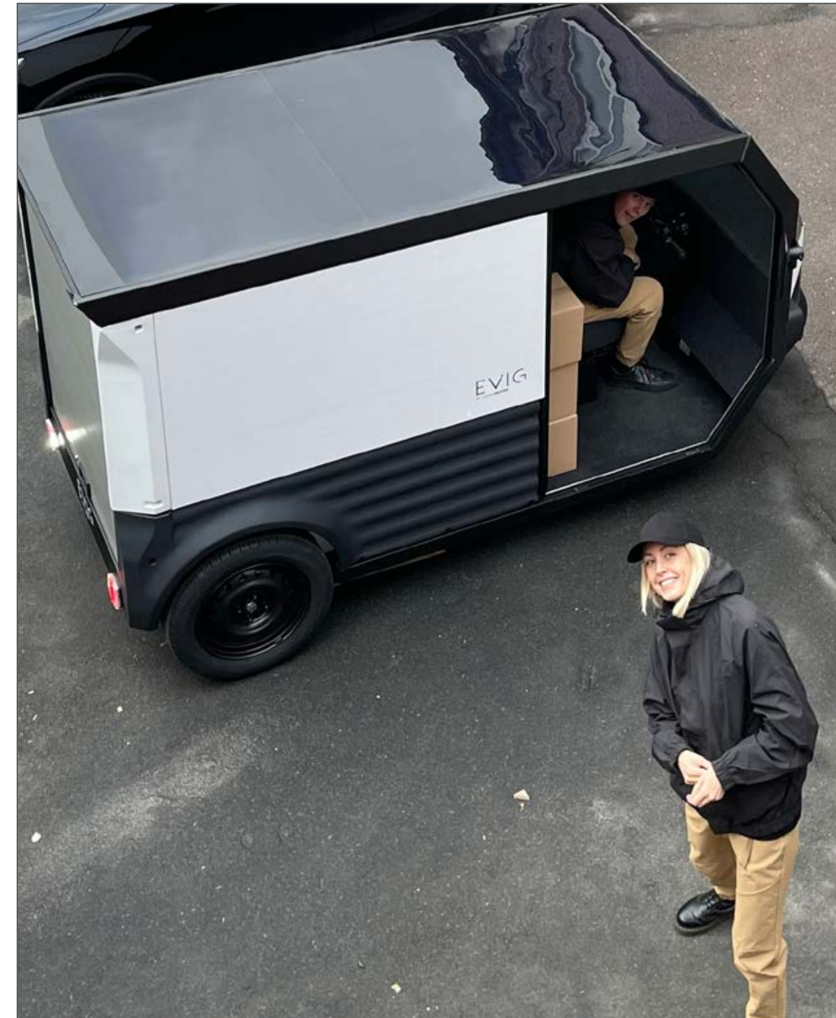
Vuonna 2023 Valoe toimitti kevyitä aurinkosähkökattoja Clean Motion EVIG-kevyt ajoneuvoon. Valoe voi toimittaa ajoneuvoon koko kattoelementin. Tämä yksinkertaistaa usein asiakkaan logistiikkaa. Kokoonpanologistiikan optimoinnin onnistuminen on oleellinen osa autoteollisuuden kannattavuutta.
