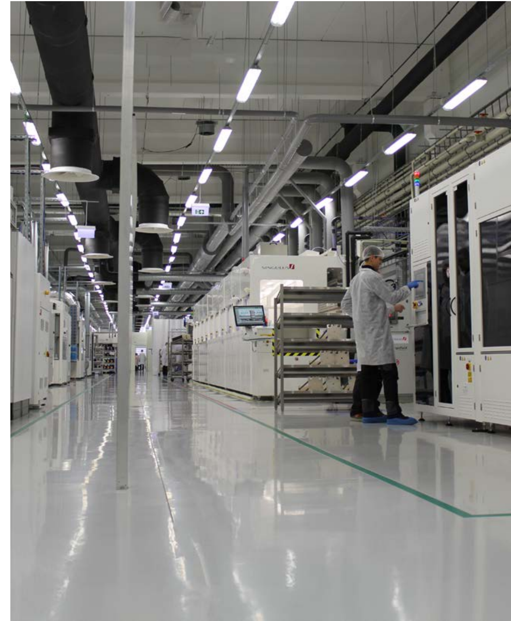
Valoen IBC-kennotehdas on tehty monipuoliseksi ja sen prosesseja voidaan muunnella asiakkaan kennotarpeeseen sopivaksi. Valoe kumppaneineen pystyy asiakkaidensa avulla kehittämään ja valmistamaan kenno-paneeliyhdistelmiä niin kannettavaan elektroniikkaan, IoT-käyttöön kuin avaruuteenkin. Liettuassa, Vilnassa toimiva IBC-kennotehdas on edelleenkin tekniikkansa kärjessä.
