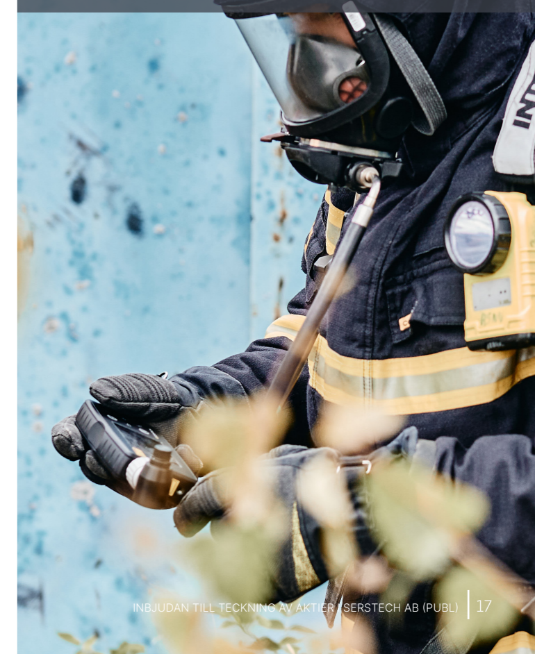
Bolagets handhållna instrument bygger på Ramanspektroskopi
