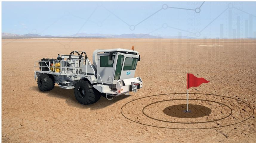
*La solution d'auto-guidance pour vibrateur permet d'optimiser le temps nécessaire au camion pour aller jusqu'au prochain point de vibration (source : Sercel).*
