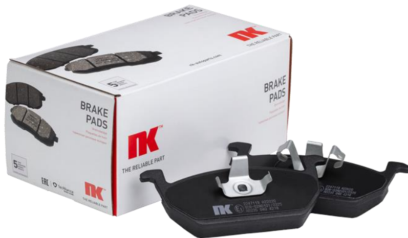
Bremseklodser med forbedret støjreducerende shims.
