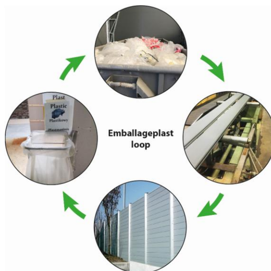
Illustration av emballageplastens resa mot ett slutet tekniskt kretslopp: Insamling/Sortering på byggarbetsplatsen, Tvättning/Pelletering, Upcykling/Extrudering, Demonterbar montering
