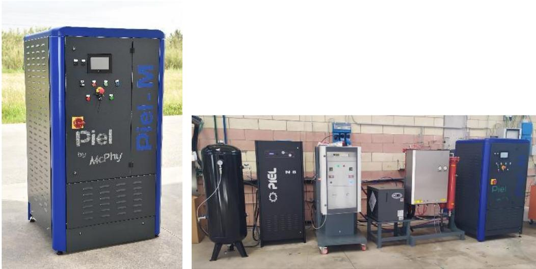
*Ligne de produits Piel équipant la ligne de production DIAX : électrolyseur (production d'hydrogène), générateurs d'oxygène, eau et nitrogène, auxiliaires (filtres, sécheur, unité de purification)*
