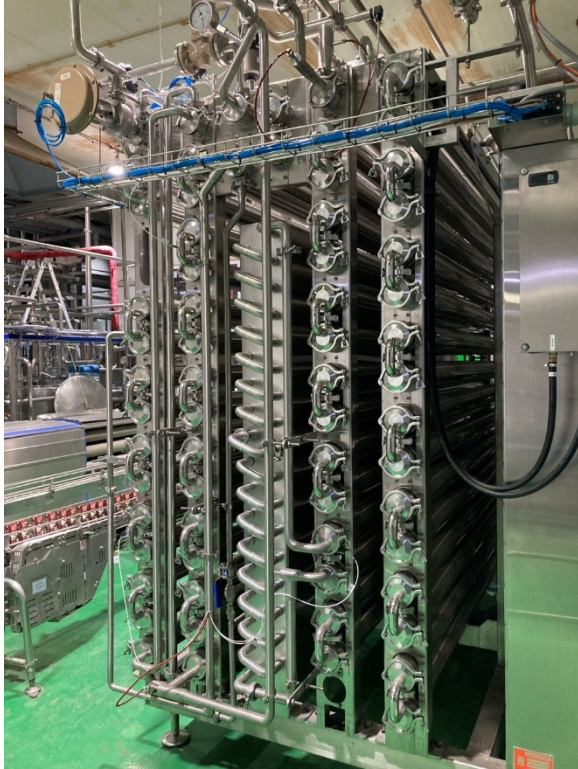
Toimitimme Mongoliaan aseptisen maidonpakkauslinjaston EL-4500+EA-40000 Vitafit Milk LLC:lle. Kuvassa on kohteeseen asennettu sterilisaattori EL-4500
