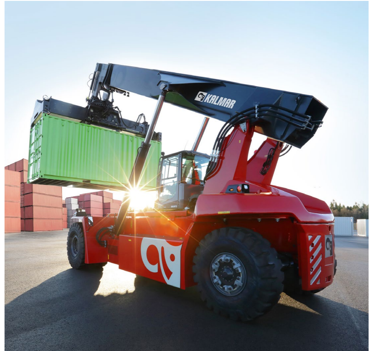
Esimerkki innovaatiosta: Kalmar julkisti joulukuussa kolme uutta täysin sähkökäyttöistä konetta, mm. sähköisen konttikurottajan.
