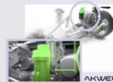
**TAMIC®** Système d'aspiration et de filtration des particules émises lors du freinage.
