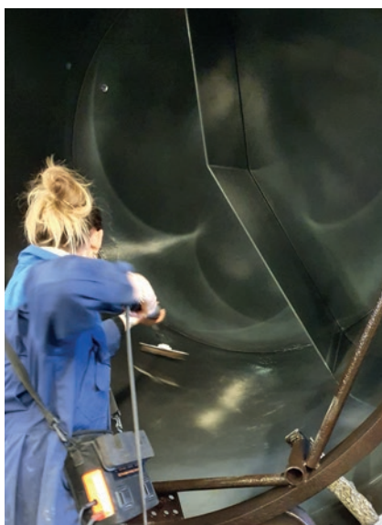
Her ses en stor beholder belagt med Accotron. Lagtykkelsen af korrosionsbelægningerne måles jævnt over hele emnet
