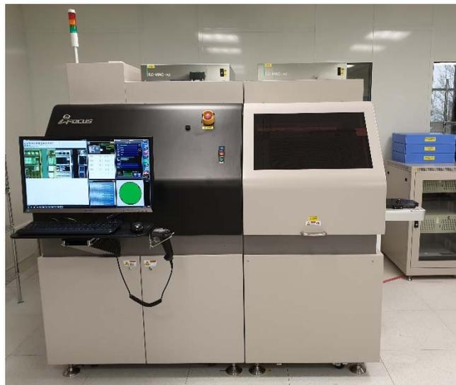
Das AOI-System ist in der Lage, 6-, 8- und 12-Zoll-Wafer vollautomatisch von Kassette zu Kassette zu verarbeiten. Es bietet auch die Möglichkeit, gesägte Wafer oder Waferteilstücke, die auf einem Filmrahmen montiert sind, zu handhaben und zu prüfen.
